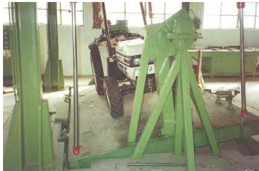
Εικ.2. Ανύψωση του λίκνου μέχρι τις 38°
