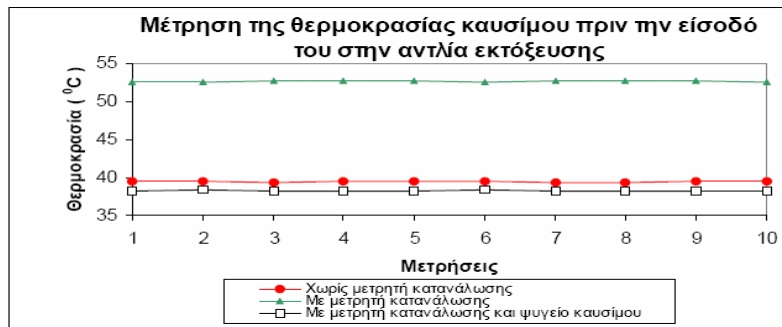
Σχήμα 6. Μέτρηση της θερμοκρασίας στην είσοδο της αντλίας εκτόξευσης.
