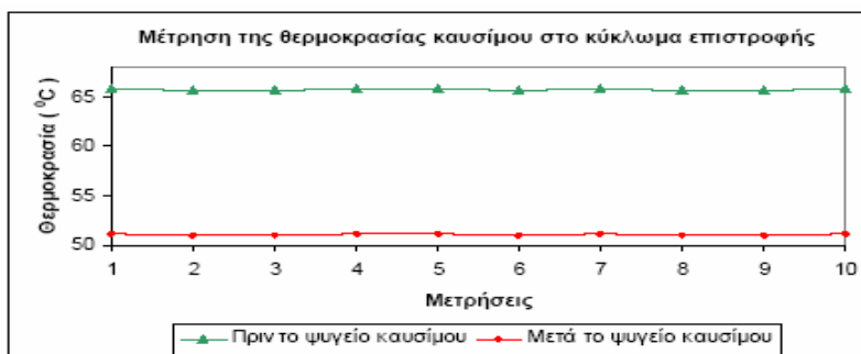
Σχήμα 7. Μέτρηση της θερμοκρασίας καυσίμου στο κύκλωμα επιστροφής.
