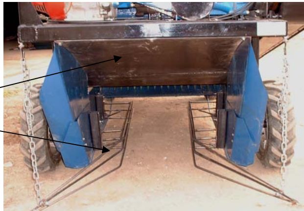
Σχήμα 7. Τροποποιήσεις του μηχανήματος για τη συγκομιδή νεαρότερων φυτών της λεβάντας
