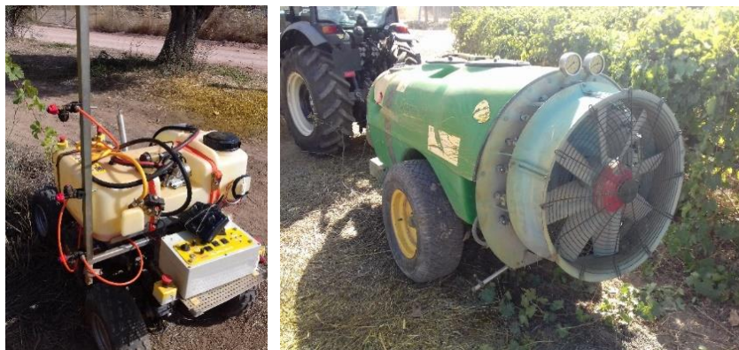
Σχήμα 2. Καινοτόμο (αριστερά) και συμβατικό ψεκαστικό (δεξιά)
