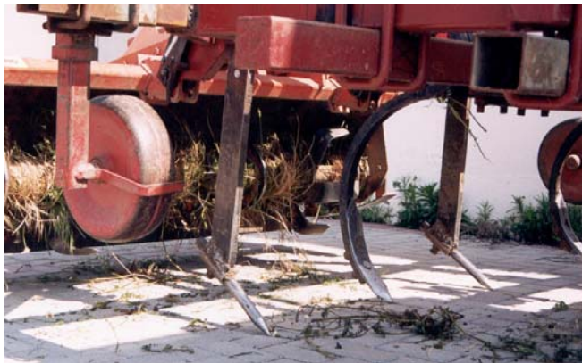
Σχήμα 2. Μηχάνημα για κατεργασία σε λωρίδες
