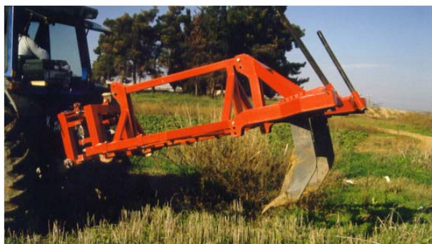
Σχήμα 2. Πλαίσιο τοποθέτησης των βοηθητικών στελεχών μπροστά από τα κύρια σε διάφορες θέσεις.
