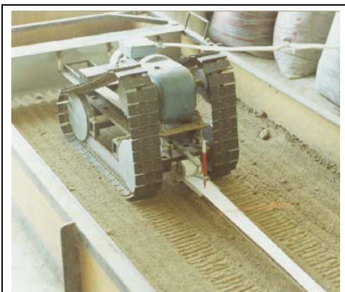
Σχήμα 1. Πειραματικός ερπυστριοφόρος ελκυστήρας κατά τη διάρκεια της δοκιμής.
