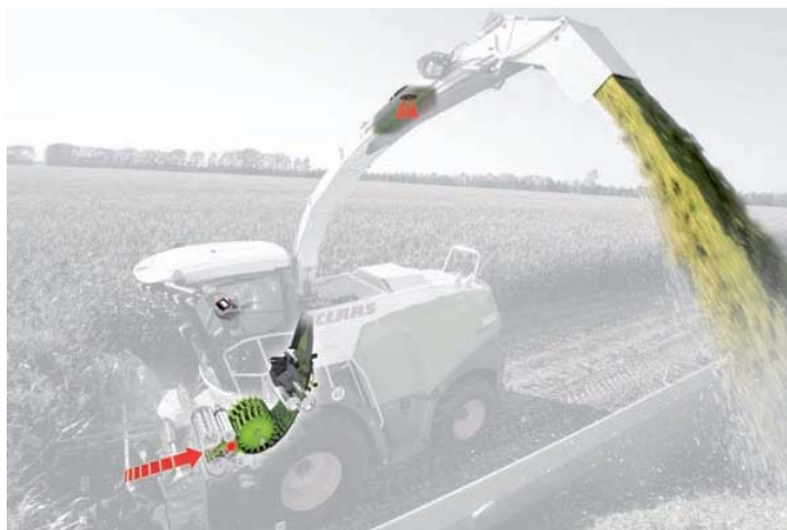
Σχήμα 5. Σύστημα συνεχούς μέτρησης υγρασίας της βιομάζας σε συνδυασμό με μέτρηση ροής μάζας (Claas Quantimater).
