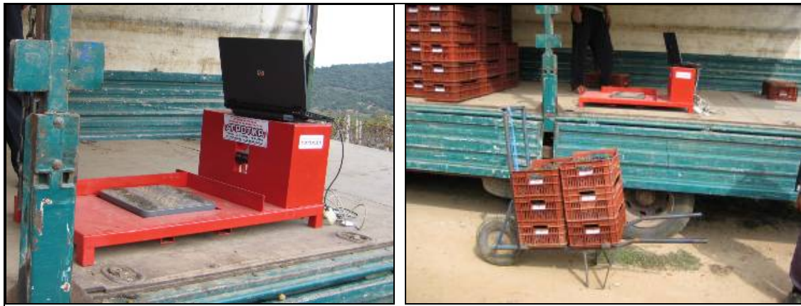
Σχήμα 1.α. Αυτοματοποιημένο σύστημα (PIWU), με αναγνώστη ραβδωτού κώδικα, ψηφιακό ζυγό και GPS β. Εκφόρτωση κιβωτίων στην καρότσα φορτηγού.
