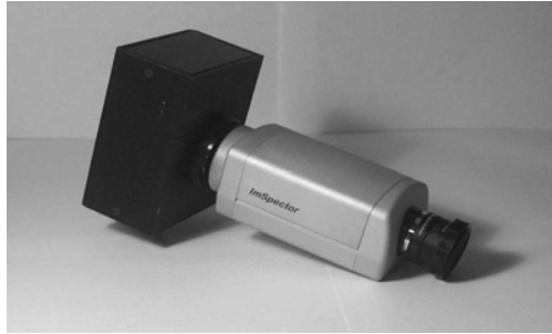
Σχήμα 1. Ο φασματογράφος Specim V9 τοποθετημένος σε μονοχρωματική κάμερα Digiteyes.
