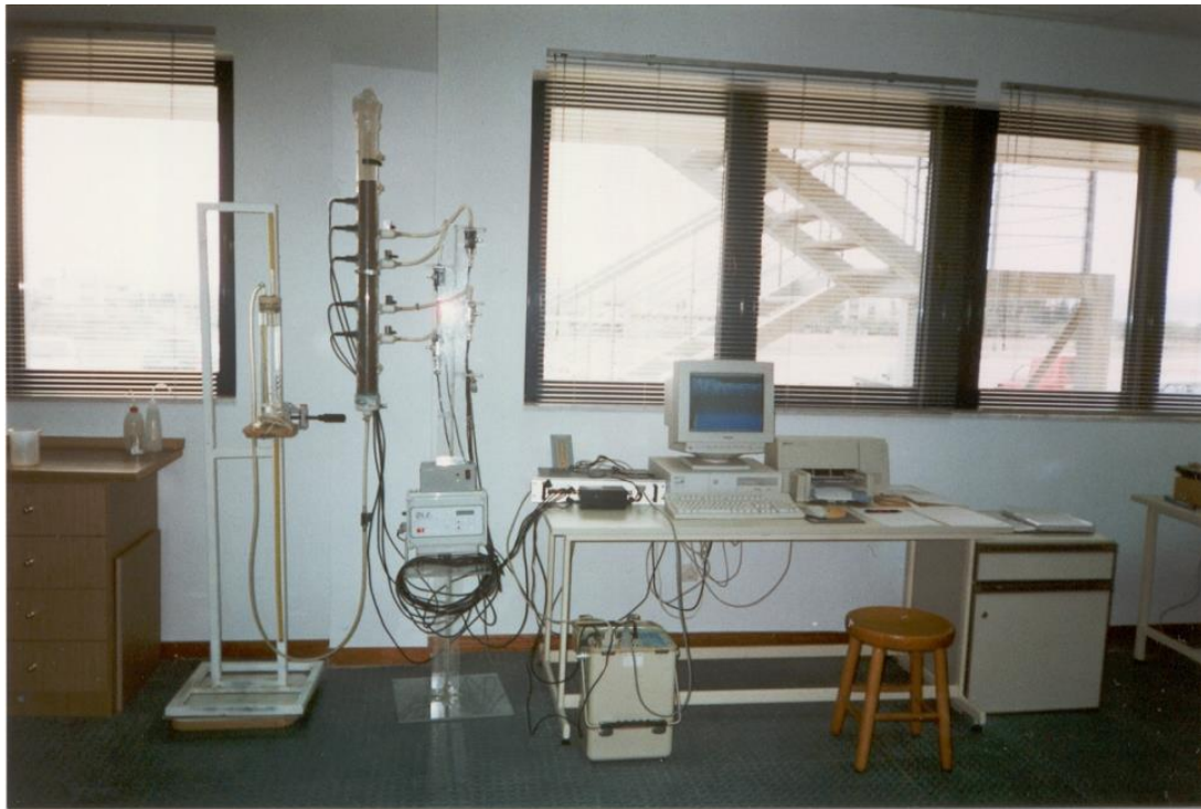
Εικόνα 1. Πειραματική διάταξη για τη μελέτη της 2ης διήθησης σε στρωματοποιημένο έδαφος
