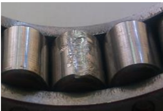
Εικόνα 4. Εκτεταμένη φθορά σε ένα εκ των κυλίστρων του εδράνου κύλισης.
