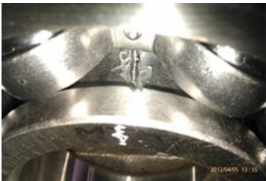
Εικόνα 3. Κάθετη αυλάκωση στον εσωτερικό δακτύλιο του εδράνου κύλισης (3mm πλάτος και 1mm βάθος).
