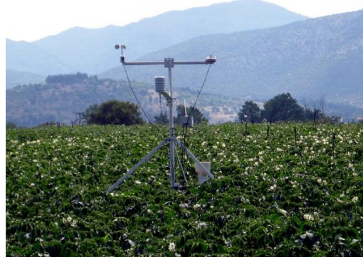
Εικόνα 2. Αυτόματος μετεωρολογικός σταθμός Γ.Π.Α. (ΑΥΑ) εγκατεστημένος σε υπόβαθρο με χαμηλή πράσινη βλάστηση και με πλήρη επάρκεια εδαφικής υγρασίας, σε όλη την διάρκεια της καλλιεργητικής περιόδου.
