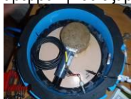
Εικόνα 8. Παρουσίαση της συνδεσμολογίας και της τοποθέτησης του δείγματος στη συσκευή Richard's
