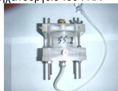
Εικόνα 14. Κύτταρο πίεσης με τα εξαρτήματά του
