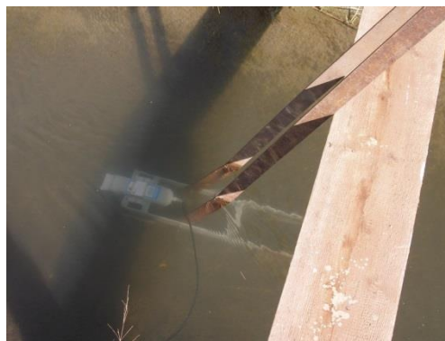
Εικόνα 3. Ιδιοκατασκευή - βάση τοποθέτησης συσκευής ADVN.
