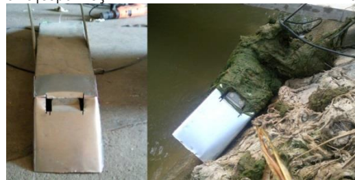
Εικόνα 4. Ιδιοκατασκευή για προστασία της συσκευής μετρήσεων από τα φερτά υλικά.
