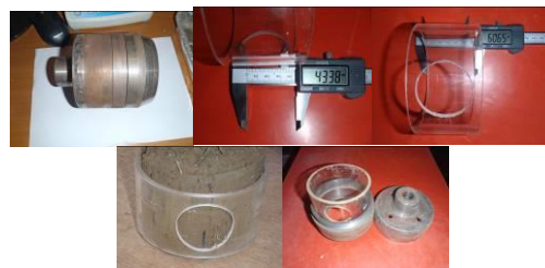
Εικόνα 1. Ο δειγματολήπτης αδιατάρακτου με τα τμήματά του καθώς και ο πλαστικός περιέκτης με τα χαρακτηριστικά του
