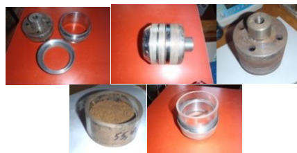
Εικόνα 13. Ο δειγματολήπτης αδιατάρακτου με τα τμήματά του καθώς και ο πλαστικός περιέκτης με τα χαρακτηριστικά του
