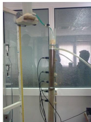
Σχ. 1. Πειραματική διάταξη για τη μελέτη αθροιστικής διήθησης
