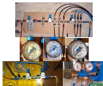
Εικόνα 4. Γραμμές ρύθμισης πίεσης για τον ηλεκτρικό αεροσυμπιεστή και για τον αεροθάλαμο πεπιεσμένου αέρα και ρυθμιστές αυτών
