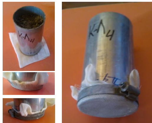
Εικόνα 11. Παρουσίαση τοποθέτησης υφάσματος και σήτας στην βάση της σωλήνας με σφικτήρα
