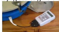
Εικόνα 8. Παρουσίαση της συνδεσμολογίας και της τοποθέτησης του δείγματος στη συσκευή Richard's
