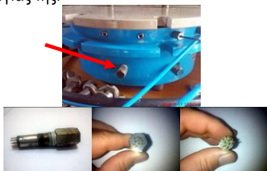
Εικόνα 6. Εξάρτημα μέσω του οποίου έγινε η σύνδεση με τη διηλεκτρική συσκευής το logger
