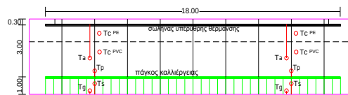
Εικόνα 4: Τομή πειραματικού σταθμού θερμοκηπίου
