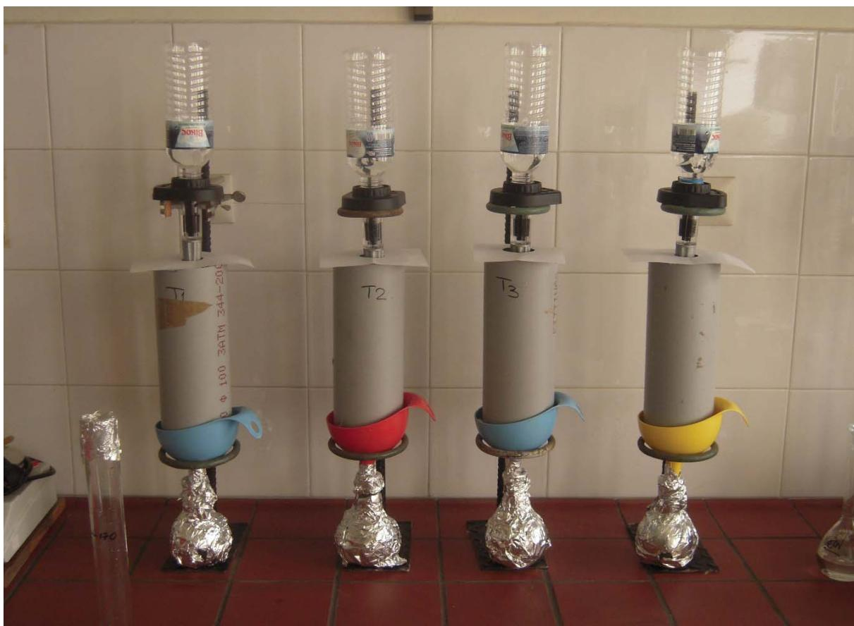
**Σχήμα 1.** Διάταξη των εδαφικών στηλών που χρησιμοποιήθηκαν στον πειραματισμό.
