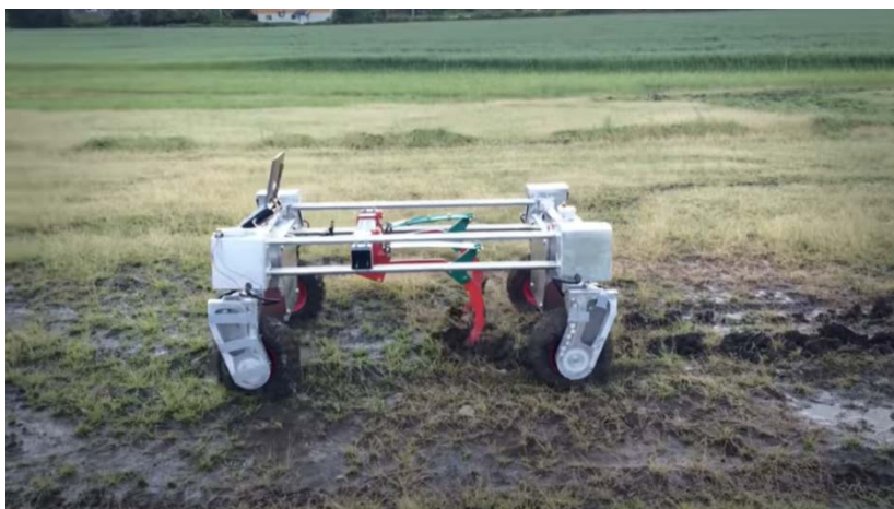
Εικόνα 1. Μη-επανδρωμένο επίγειο όχημα (Unmanned Ground Vehicle-UGV)
