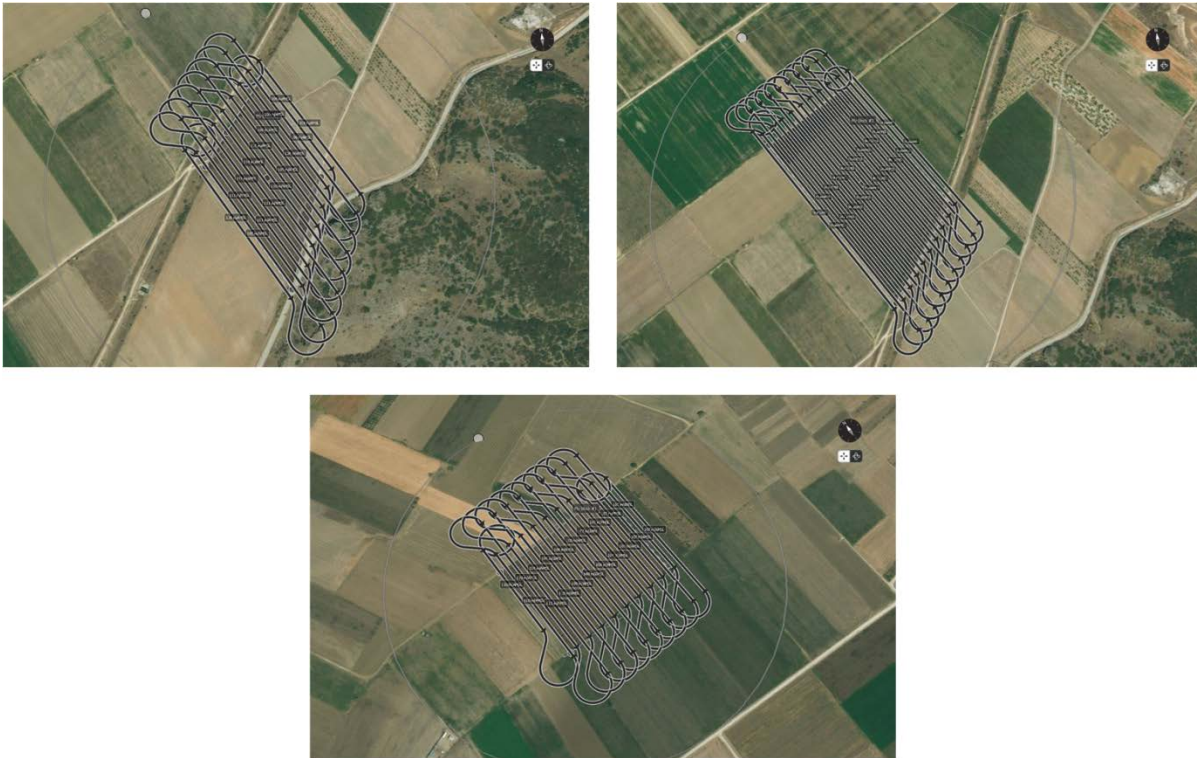
Σχήμα 3. Σχέδια πτήσης UAV για τους τρεις οπωρώνες καρυδιάς που χρησιμοποιήθηκαν για την ανάπτυξη, εκπαίδευση και επαλύθευση του συστήματος.
