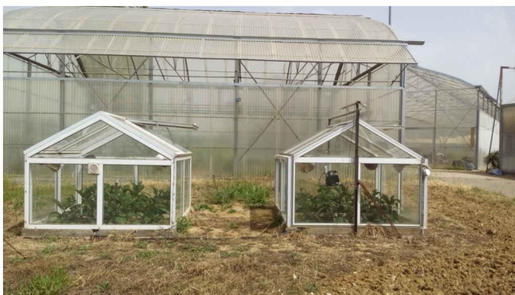
Εικόνα 1. Τα πειραματικά θερμοκήπια, εξοπλισμένα με σύστημα υπέρυθρη θέρμανσης (αριστερά) και συμβατικής θέρμανσης (δεξιά) αντίστοιχα.
